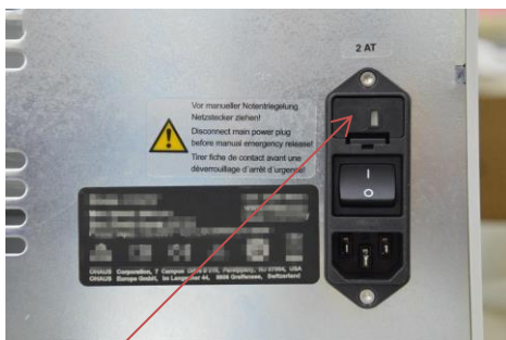
Cassetto portafusibili con fusibile 4 AT
